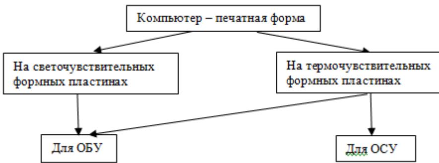
Рисунок 2. Классификация способов изготовления офсетных печатных форм по технологии Computer - to - Plate
